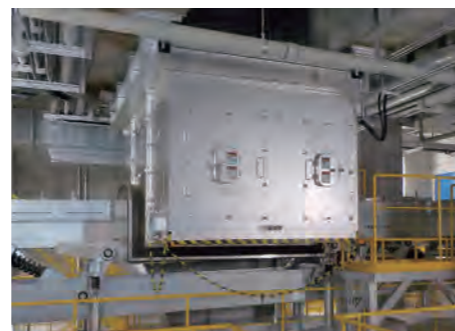
磁選機 ごみに含まれる鉄を回収し有効利用します。
