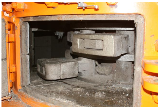
▲粗大・不燃ごみは破碎し、鉄類・アルミ類を回収
