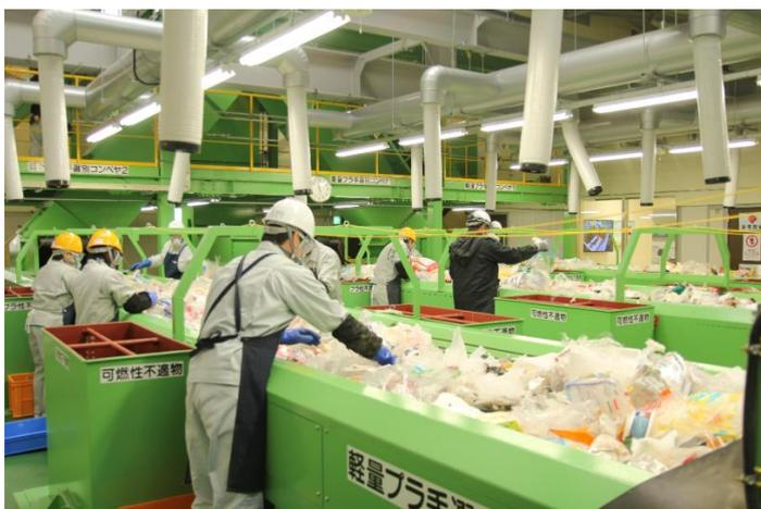
▲プラスチック製容器包装の手選別処理
