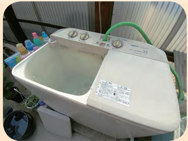
上の写真は二槽式洗濯機と呼ばれるタイプの洗濯機で「洗う槽」と「脱水槽」に分かれています。
