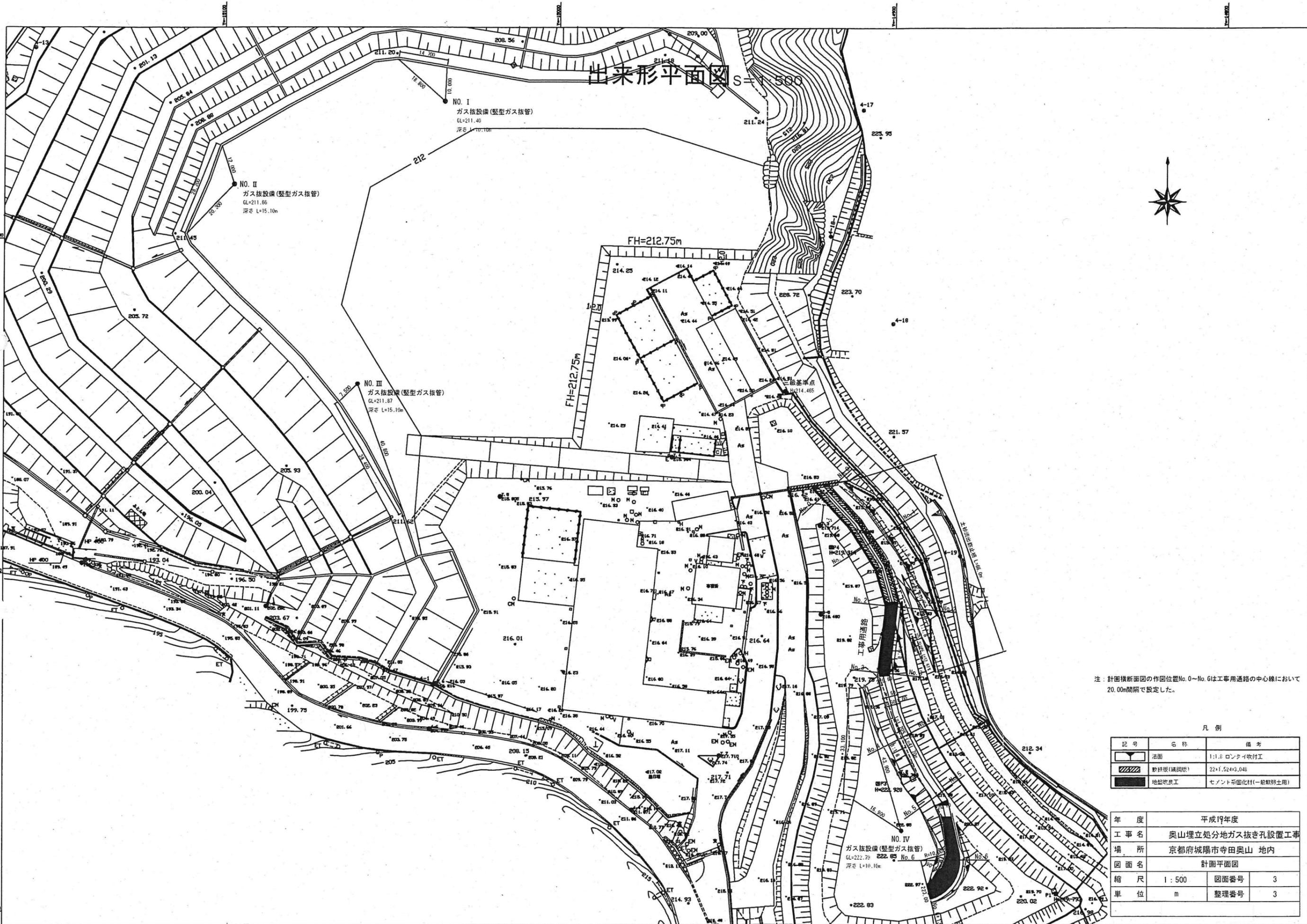
注：計画断面図の作図位置No.0~No.6は工事用通路の中心線において20.00m間隔で設定した。
