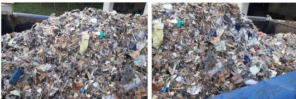
図 2-4 粗大・不燃ごみの処理残渣の状態
