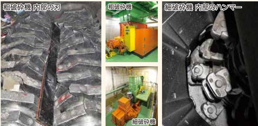
粗破碎機と細破碎機の2種類の破碎機で、ごみを細かく碎きます。粗破碎機は、二軸の刃によりごみを挟み込み、40cm程度に碎きます。細破碎機は、28個のハンマーを高速回転させ、15cm程度に碎きます。
