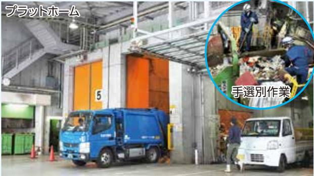
プラットホームから、ごみが、ごみピットに投入されます。ごみピットに貯まったごみは、クレーンで受入れホッパに投入し、手選別で不適物を除去したあと、各破碎機へ送られます。
