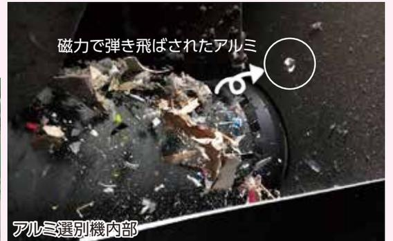
破碎されたごみは、各種選別機で鉄、アルミ、不燃物、可燃物、プラスチック類に分別します。上記写真は、アルミ選別機です。高速回転する磁石とアルミの間に生じる反発力を利用して選別します。その他の選別機として、磁選機、粒度選別機、風力選別機があります。
