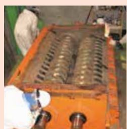
▶刃が全て取り外された粗大破砕機のシャフト。この後、新たなシャフトに交換されます。
