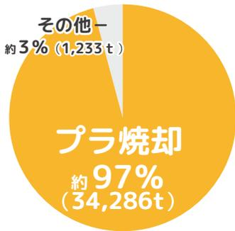
プラスチック焼却のCO<sub>2</sub>排出係数はとても高く、1kgを焼却するだけで約2.8kgのCO<sub>2</sub>を排出します。
